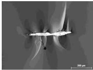
Inclusion de sulfure de nickel ( float )
